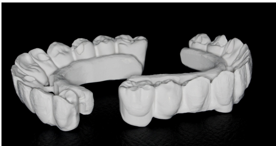
Zirkongerüste mit Sinterstützstruktur.
