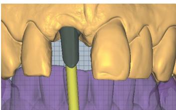
Konstruktion des Abutments.
